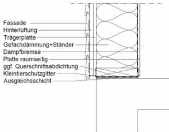
Abb. 3: Putzfassade mit Trägerplatte
